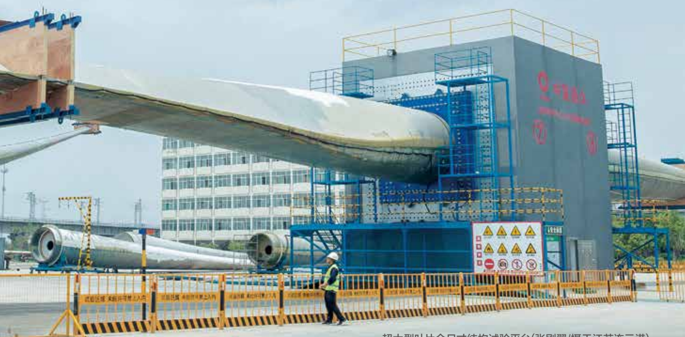
超大型叶片全尺寸结构试验平台(张刚翼/摄于江苏连云港)
