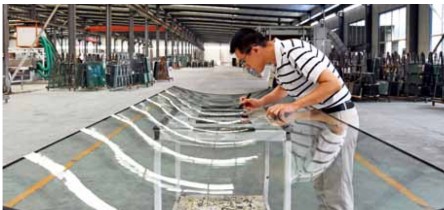
检查曲面复合防火玻璃表面透通性
